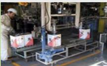
出来上がって塗料を検査完了後、ろ過し容器に充填します。
