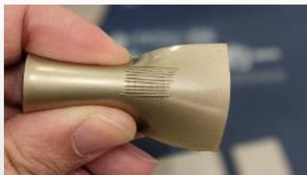
ウレヒーローラスクリをSBRゴムへ塗装し碁盤目試験を実施
