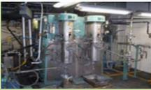
前練りしたミルベールを分散機に送り、粒子を細かく分散します。
